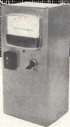
Questo articolo illustra i criteri di costruzione di un misuratore di battiti cardiaci (cardio-tachimetro). Basterà posare un dito sull'apparecchio per ottenere la lettura istantanea delle pulsazioni cardiache.
