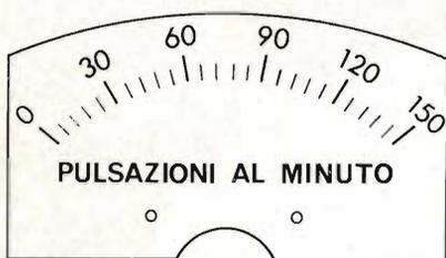
Fig. 3 - Esempio di scala da sostituire al microamperometro.
